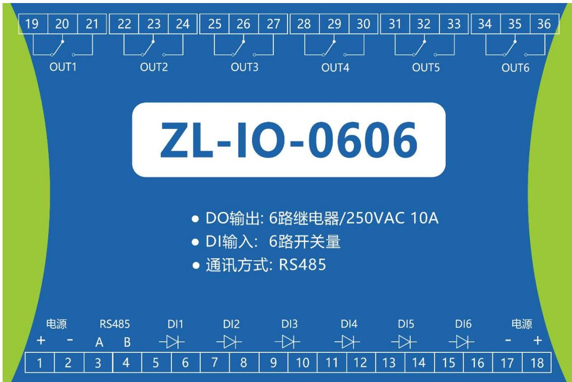
图 1 ZL-IO-0606 接口引脚图 (TOP View)
