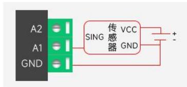
AI模拟量三线传感器接法
