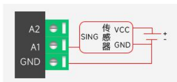
AI模拟量三线传感器接法
