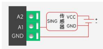
AI模拟量三线传感器接法
