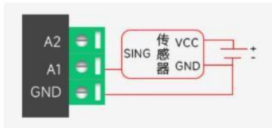
AI模拟量三线传感器接法
