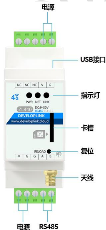
图 1 ZL440 DTU 插针引脚图 (TOP View)
