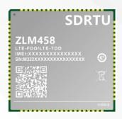
ZLM458 是 DEVELOPLINK 推出的新一代 LTE Cat1 无线通信模组,该模组采用了国产芯片方案,支持最大下行速率 10Mbps 和最大上行速率 5Mbps; 封装上采用了 22.9\*23.9\*2.4mm 的更小尺寸,方便客户的设计尺寸需求,丰富的引脚定义,满 足客户的多媒体以及 OPEN 开发的需求。
